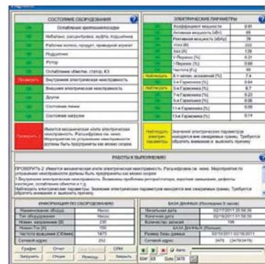
Система **Вектор-ЭС** предназначена для комплексного непрерывного мониторинга электрооборудования и может устанавливаться на трехфазные двигатели переменного тока (в т.ч. с ЧРП) и генераторы переменного тока.
