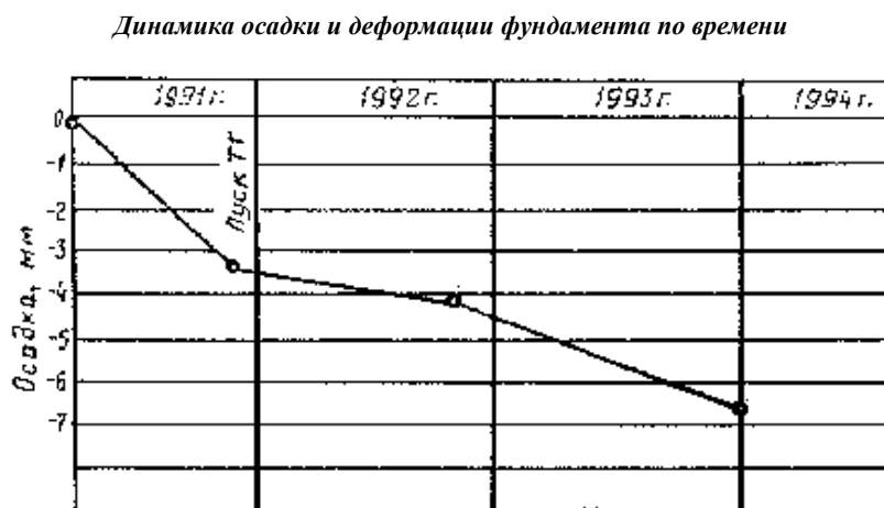
Рис. 8. Формуляр осадки и деформаций фундамента турбоагрегата: М1/16 – деформационная марка, установленная на отметке обслуживания и в подвале, числитель – левая сторона, знаменатель – правая
