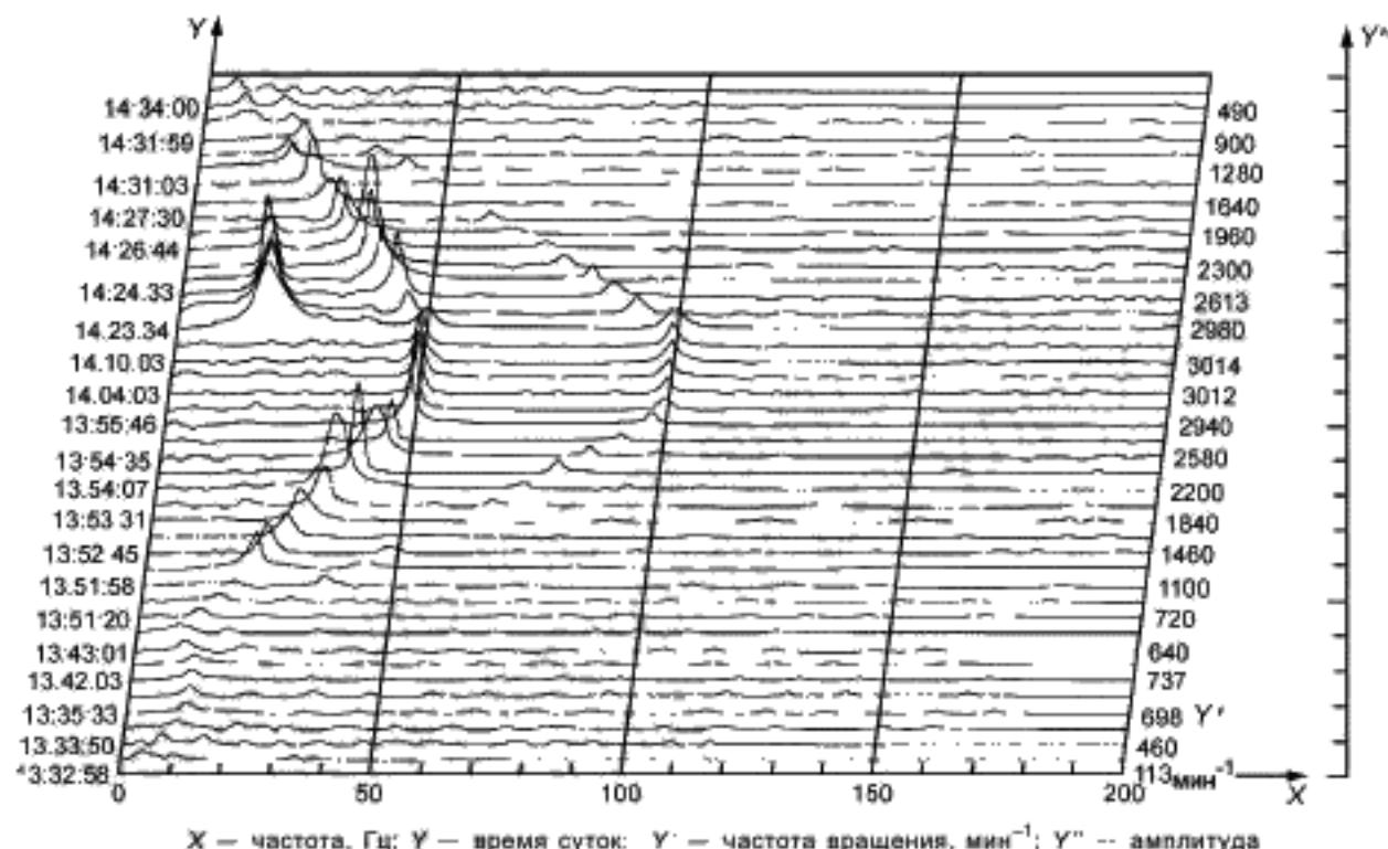
Рисунок 24 — Каскадный спектр вибрации турбины
