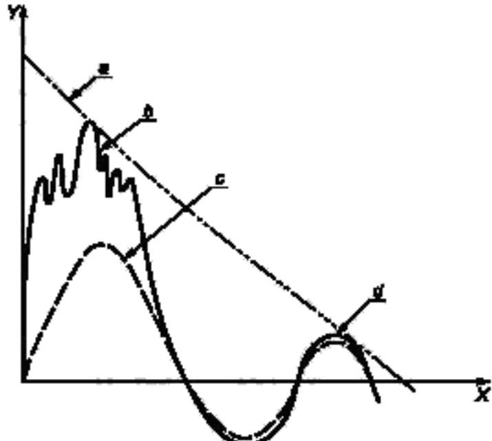
$X$  — время;  $Y$  — значение сигнала;  $a$  — экспоненциально затухающая огибающая линия сигнала;  $b$  — сложный состав колебаний в начале переходного процесса;  $c$  — колебания на низшей собственной моде;  $d$  — затухающие колебания
