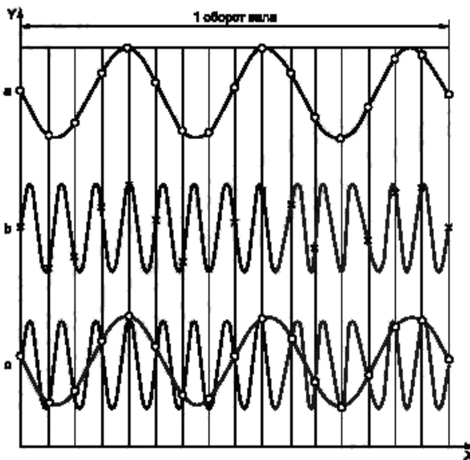
*X — время, Y — значение сигнала; a — 3-я гармоника оборотной частоты; b — 13-я гармоника оборотной частоты, с — 3-я и 13-я гармоники оборотной частоты с совпадающими выборочными значениями сигнала*
