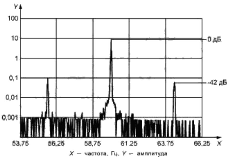
Рисунок 18 — Спектр вибрации неисправного электродвигателя
