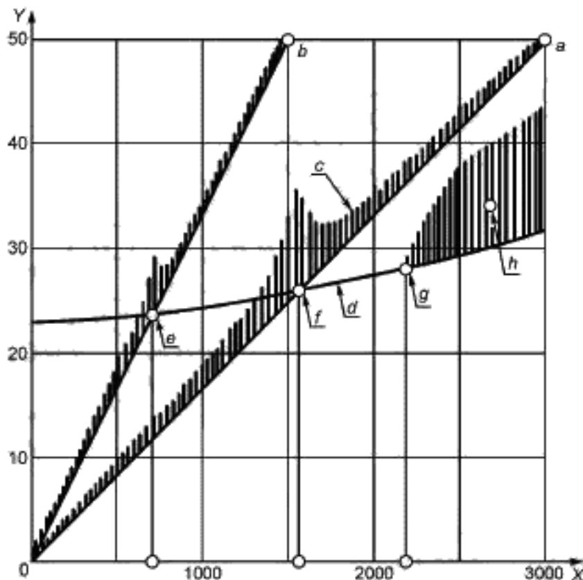
$X$  — частота вращения,  $\text{мин}^{-1}$ .  $Y$  — частота, Гц.  $a$  — 1-я гармоника частоты вращения;  $b$  — 2-я гармоника частоты вращения;  $c$  — амплитуда;  $d$  — собственная частота;  $e$  — резонансная частота вращения;  $f$  — резонансная частота вращения;  $g$  — граница области нестабильности;  $h$  — субгармоники, появляющиеся при нестабильном поведении ротора
