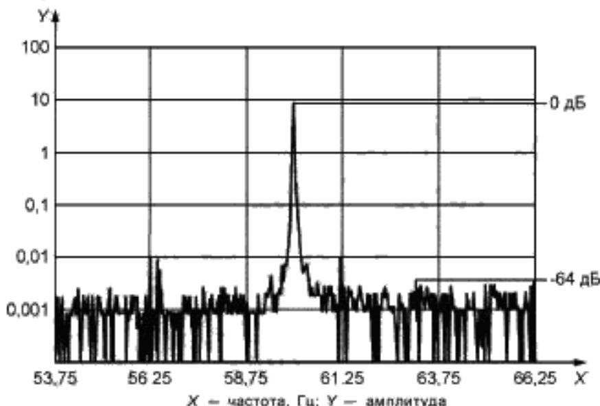
Рисунок 17 — Спектр вибрации исправного электродвигателя
