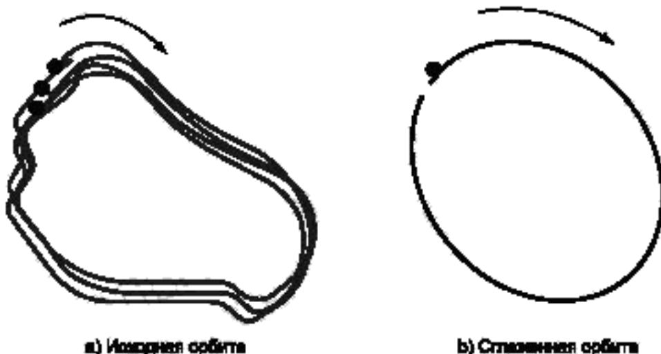
Рисунок 11 — Орбита прецессии вала
