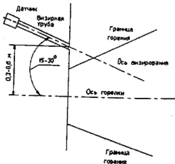
Рисунок 24 - Эскиз установки датчика ФДЧС-1МК
