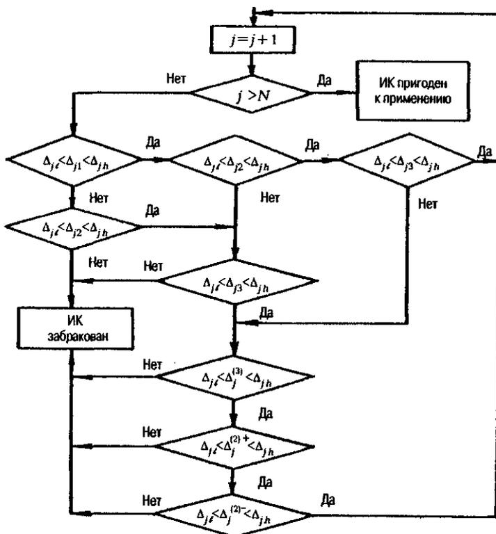
Рис. 1. Блок-схема алгоритма определения пригодности ИК к применению
