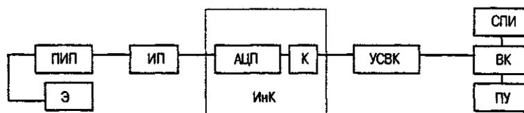
**Рис. П 4.1. Структурная схема проведения эксперимента при калибровке ИК комплексным методом:**
